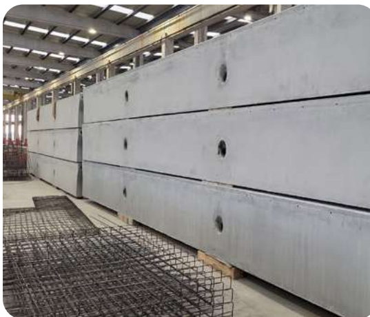
Fabricación pantalán flotante (durante las obras).
